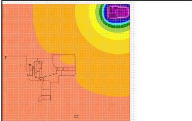
Distribución del potencial de la superficie en presencia de un electrodo flotante.
