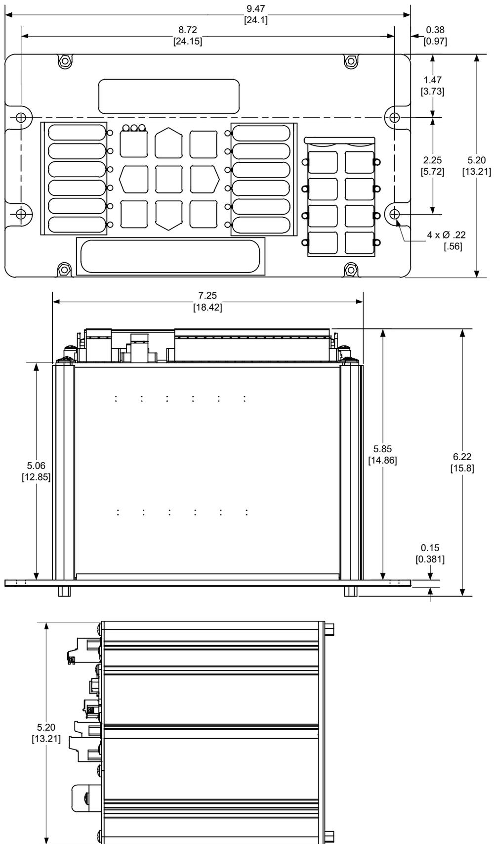
Figura 8 Dimensiones externas del modelo horizontal de M-7679
