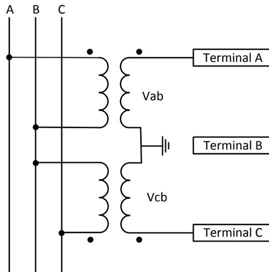
Figura 5 Diagrama Ejemplo de Delta Abierta CA
