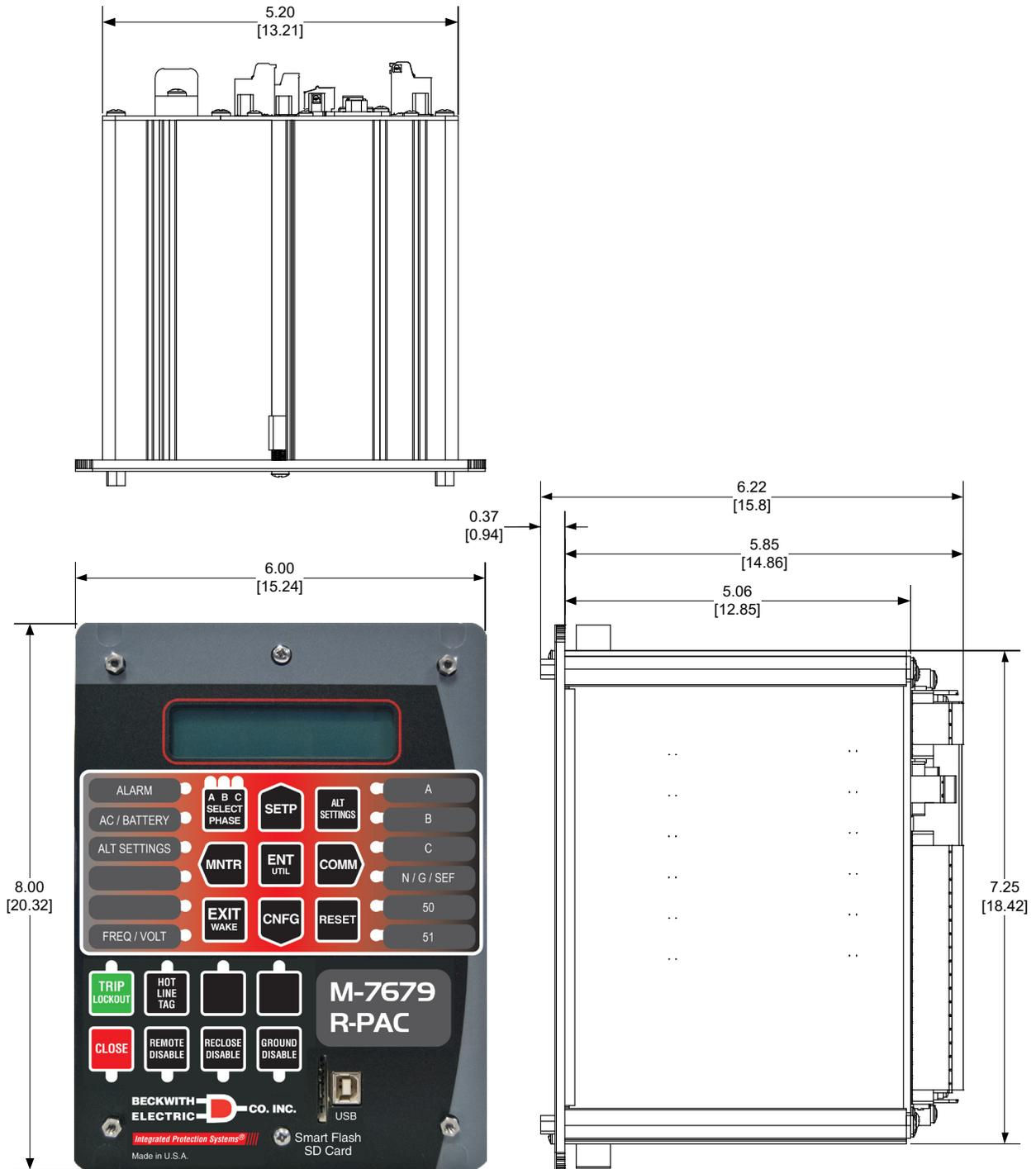
Figura 7 Dimensiones externas del modelo vertical de M-7679
