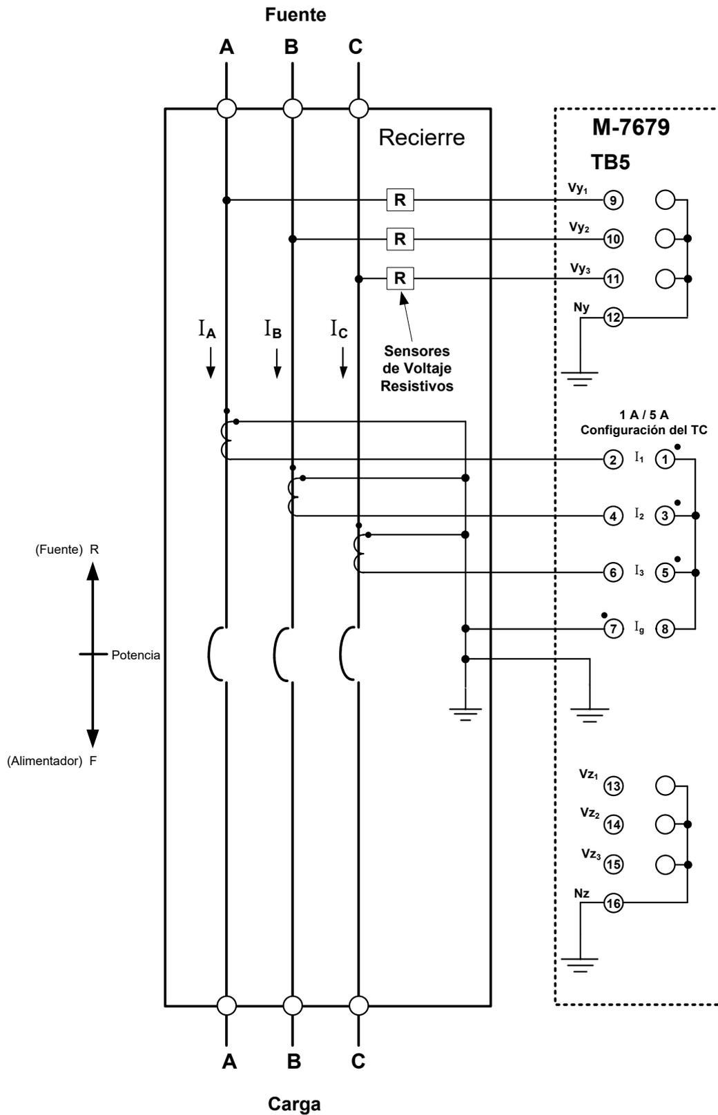
Figura 6 Diagrama de conexión de tres líneas M-7679
